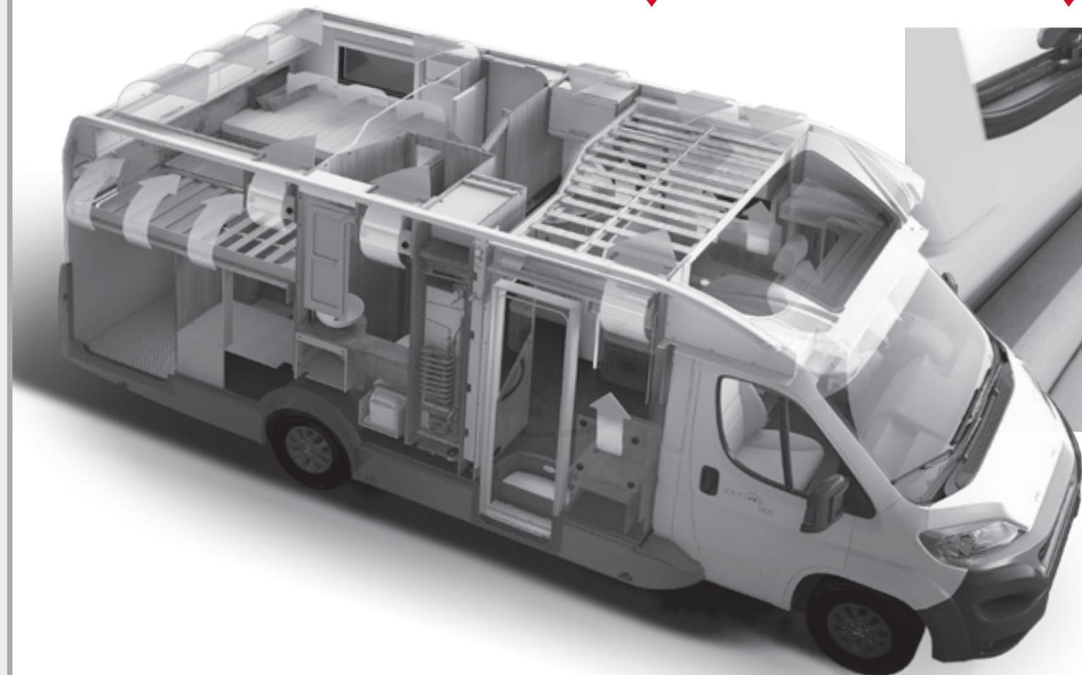
**Paneles anticondensación** separados de la propia pared en la zona de día y en la zona de descanso que permiten que circulen el aire y el calor.
